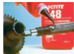
▲ Figure 15. Des cannelures collées
