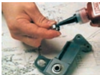
◀ Figure 28. ▲ Le collage de roulements
