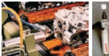
▲ Figure 27. Le collage par roto-spray
