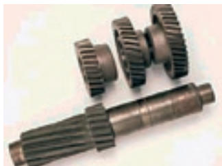
▲ Figure 29. Le collage de roues dentées
